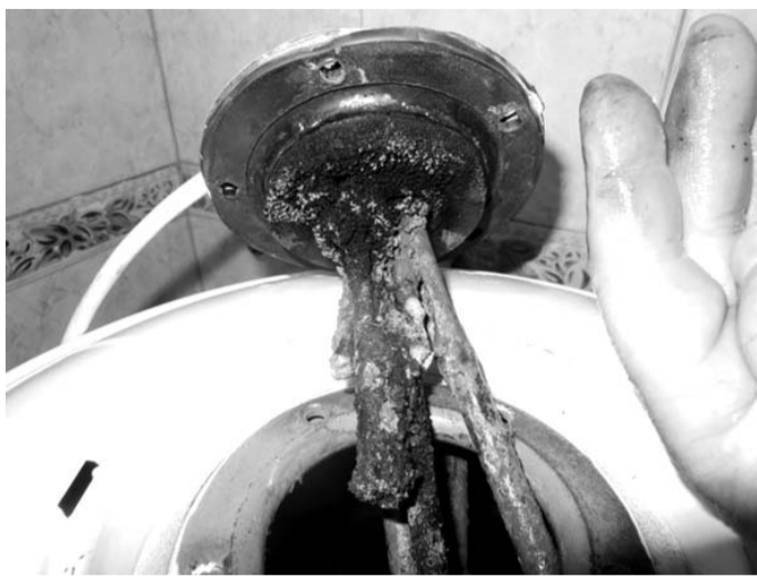
Этот тэн прослужил менее года и буквально «съеден» ржавчиной и какой-то чернотой.
